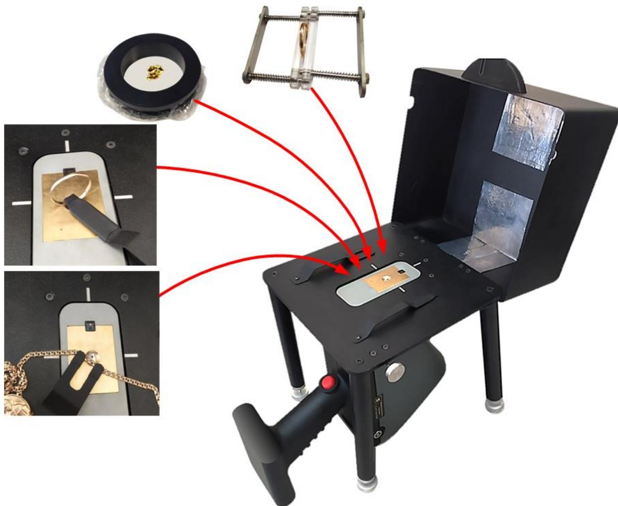
Устройство точного позиционирования, зажимы и держатели для анализа мелких образцов
